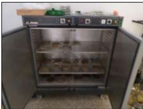
Photo 1. Séchage à l'étuve
