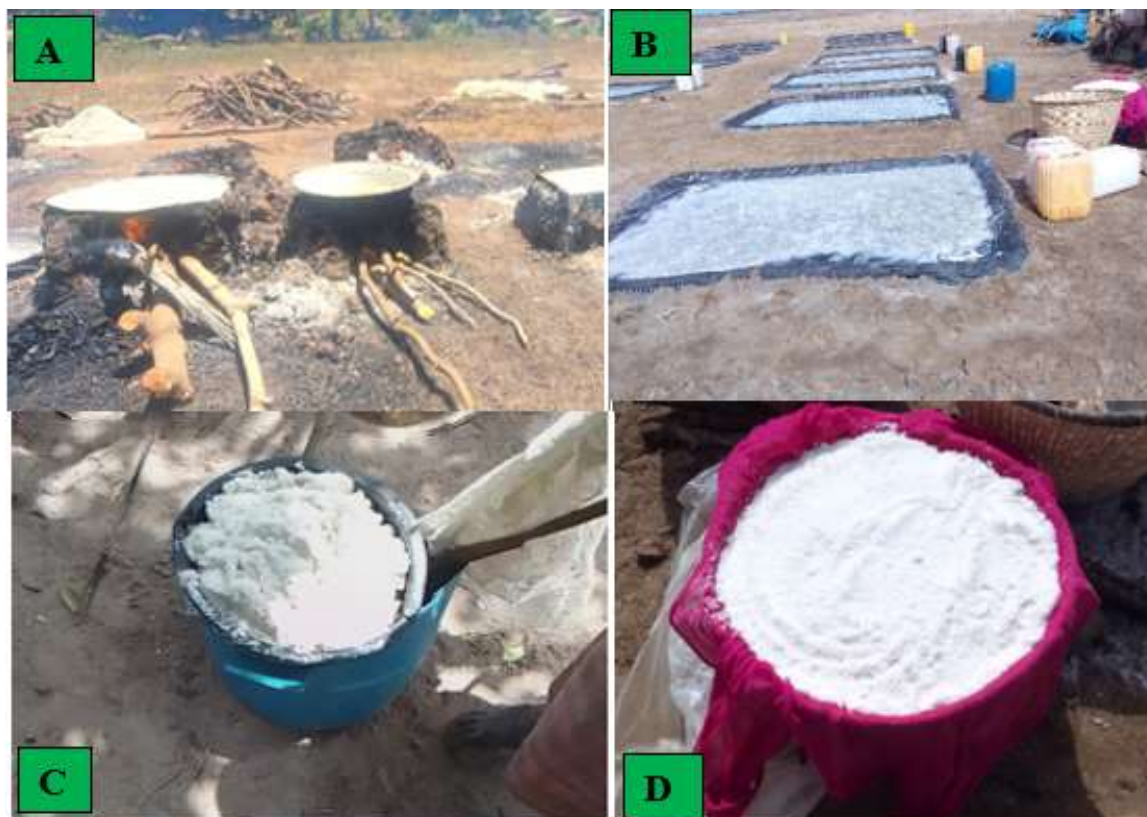
Photo 1 : Saliculture ignigène à Bambali (A) ; Saliculture solaire sur bâche à Thionck-Essyl (B) ; Sel produit par la méthode ignigène (C) et Sel produit sur bâche solaire (D)
