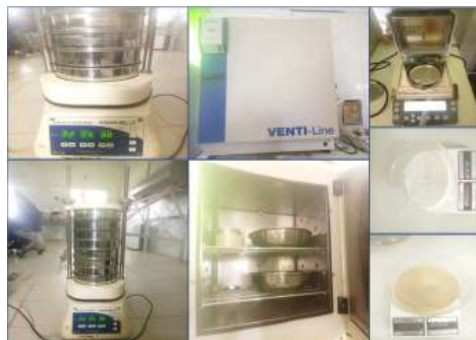
Planche photographique 2 : Appareils utilisés pour l'analyse granulométrique au laboratoire de Chimie et de Physique des Matériaux de l'UASZ
