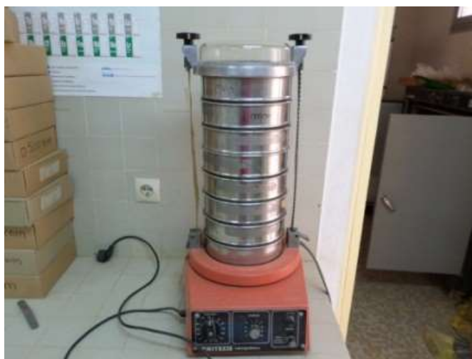
Photo 3. Colonne de tamis disposée sur un agitateur
