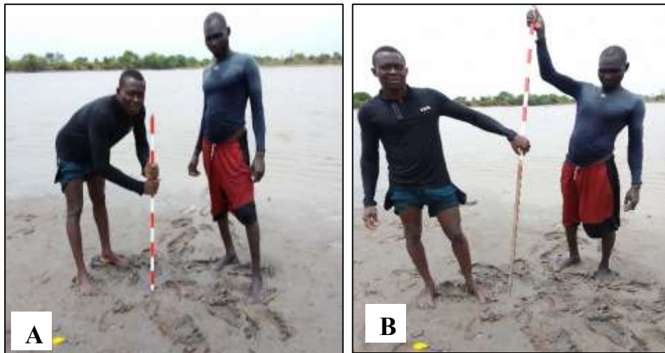
Planche 1. Mesure de l'épaisseur des alluvions dans la marre
